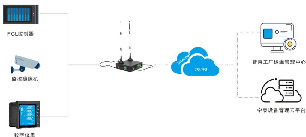
G9306系列4G工业网关，可实现工业生产现场的PLC、HMI、工业高清摄像头与网关连接，通过网关进行数据采集、数据预处理、数据分析。并通过MQTT、HTTP协议并上报到云端系统。云平台可实现设备远程状态监控，故障诊断分析、实时告警，实现可视化、帮助中小企业实现一套工业智能远程运维管理系统解决方案。
